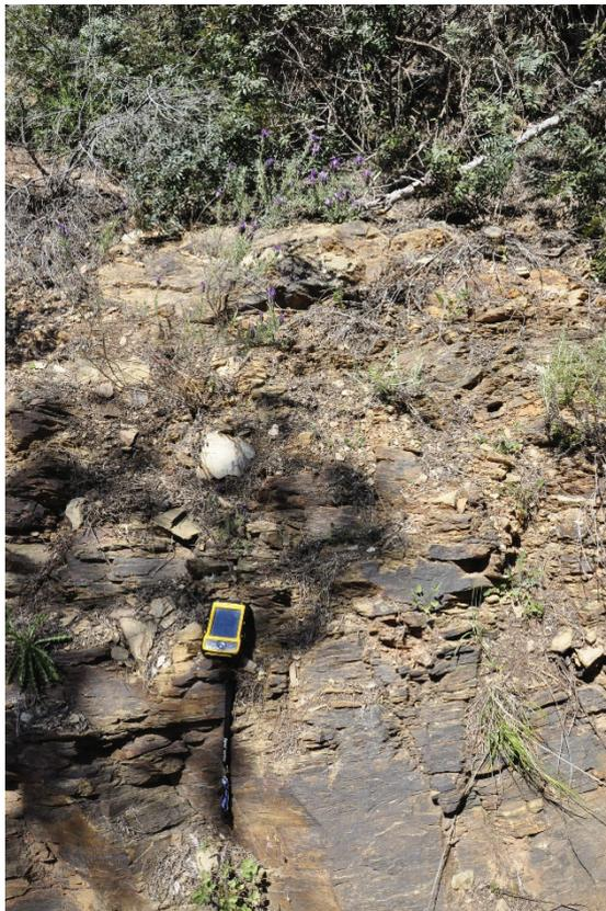
Figura 28 - Fotografia **V376**. Esiguo spessore della coltre di alterazione superficiale e giacitura a reggipoggio delle discontinuità della roccia costituente il substrato
