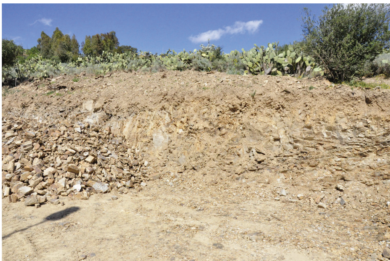
Figura 5 - Fotografia V405 . Nuovo taglio stradale che mette in evidenza lo stato del substrato roccioso e lo spessore dei detriti superficiali.
