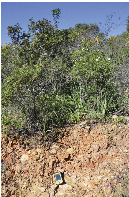
Figura 26 – Fotografia V370 . La coltre di alterazione superficiale è quasi assente o presente con spessori minimi
