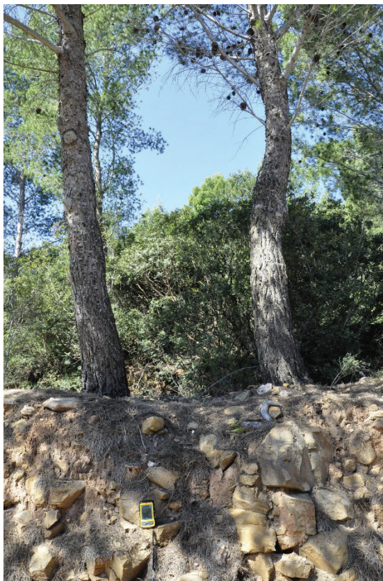
Figura 27 – Fotografia V374 . Esiguo spessore della coltre di alterazione superficiale
